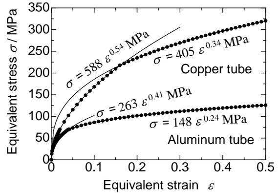
FIG. 6 STRESS-STRAIN CURVES OF THE ALUMINUM ALLOY TUBE AND THE COPPER TUBE (A).
