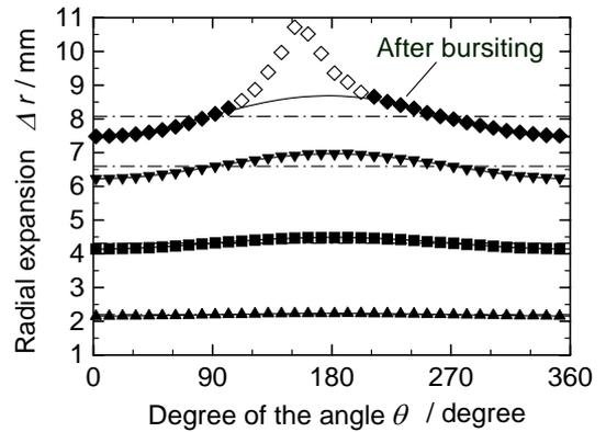
FIG. 7 DISTRIBUTION OF RADIAL EXPANSION OF COPPER TUBE AT THE AXIAL CENTER OF THE TUBE ( $\tau_{ini} = 3.9\%$ ).
